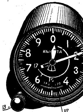
Рис. 31 Внешний вид высотомера ВД-17
