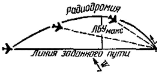
Рис. 58. Полет на радиостанцию пассивным способом
